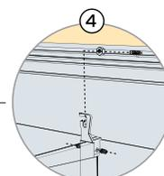
Assemblage attache panneaux et moulures de cadre
