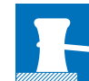
E7 Autorisation de s'amarrer du côté de la voie où le signal est placé
