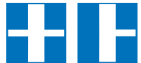
E9 a & b Les voies rencontrées sont considérées comme affluentes de la voie suivie
