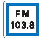
CE22* Fréquence radio dédiée à la circulation routière et l'état des routes
